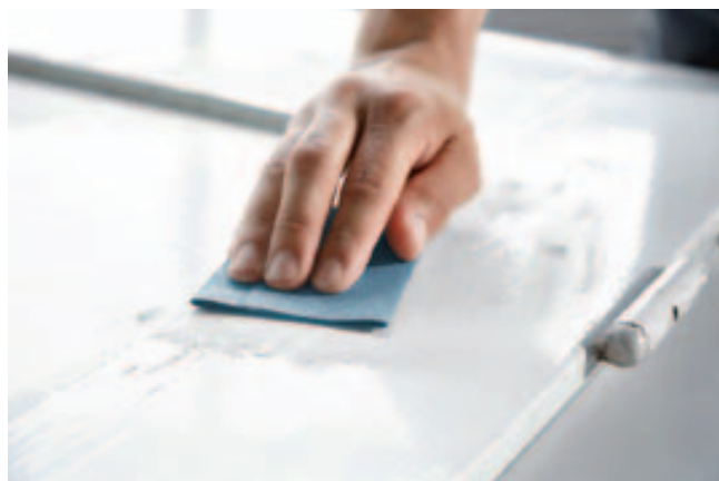
Tlenek glinu zapewnia wysoką wydajność szlifowania oraz długą żywotność materiałów ściernych, dzięki temu praca z nimi jest szybka.
