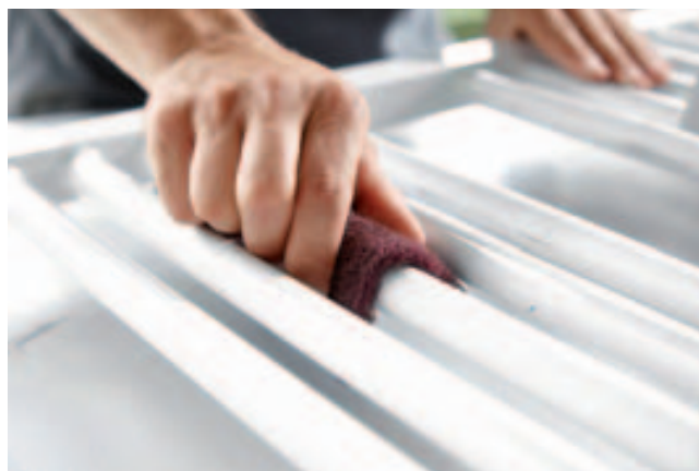
Włókny: wykonane z elastycznego materiału, który dostosowuje się do kształtu wykańczanej powierzchni, dzięki temu znajduje swoje zastosowanie przy szlifowaniu płaszczyzn o skomplikowanych profilach.
